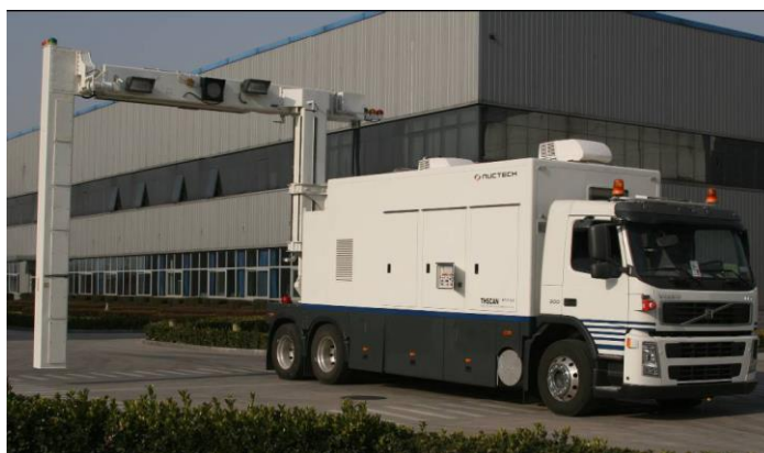
图 9-1 MT1213DE 车载式移动集装箱检查系统（无扫描大厅时）
